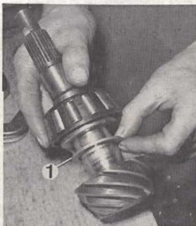
Mise en place de la rondelle de réglage de la distance conique (1), chanfrein côté pignon.
