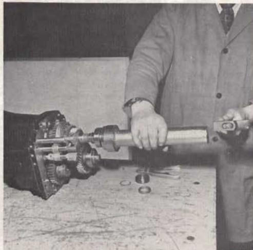
Montage du roulement arrière d'arbre secondaire.
