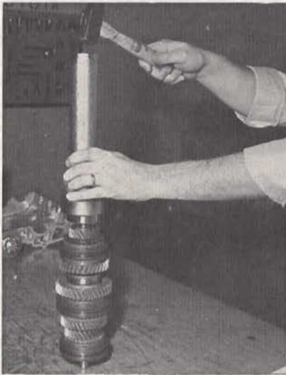
Montage du roulement arrière à l'aide de l'outil 09309-36020.
