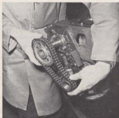
Dépose de l'ensemble pignons d'arbre à cames et de vilebrequin et de la chaîne.
