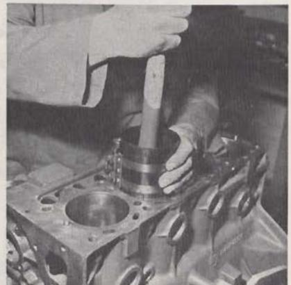
Mise en place des ensembles bielle-piston à l'aide d'un collier à segments.
