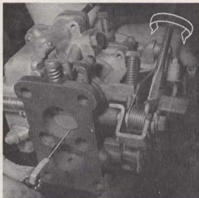
Contrôle et réglage de l'ouverture positive du papillon.
