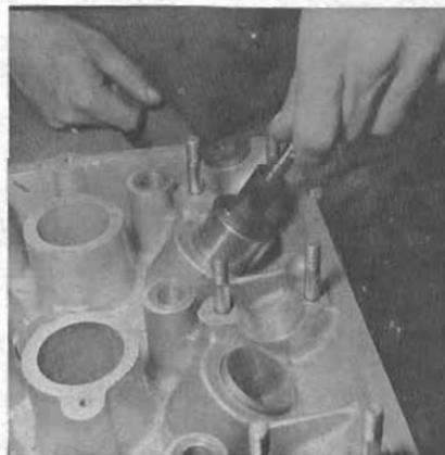
Dépose à l'aide d'une ventouse des poussoirs de soupapes.
