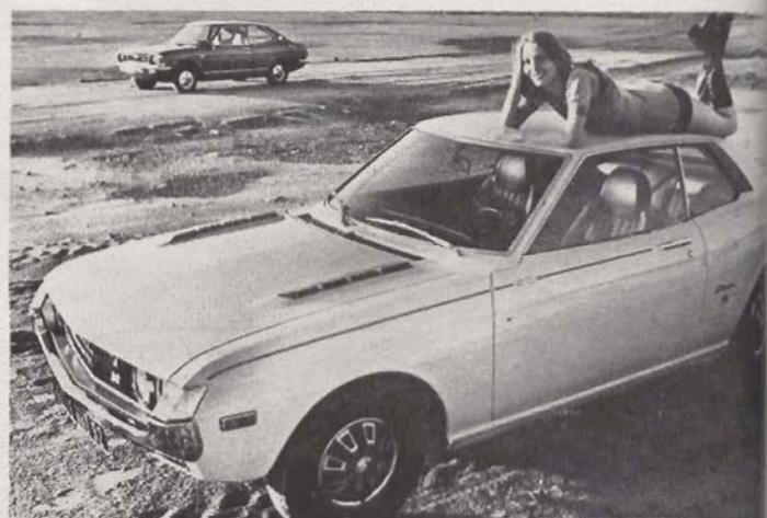
Le coupé « Celica ST » lancé en 1971 est équipé d'un moteur 1 600 cm<sup>3</sup> à arbre à cames latéral et d'une boîte 5 vitesses
