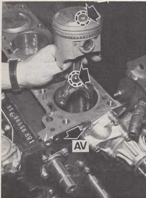
Orientation de l'ensemble bielle-piston au montage dans le cylindre.
