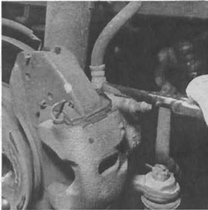
Dépose des épingles des clavettes des freins avant.
